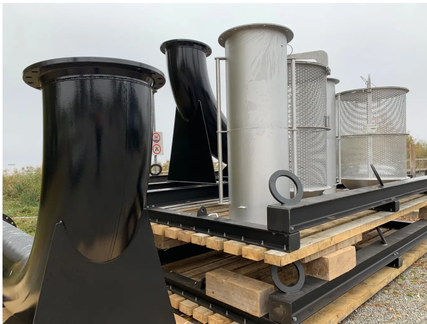
(3) Zwei komplette Seiher mit Einlaufbauwerk (schwarz).
