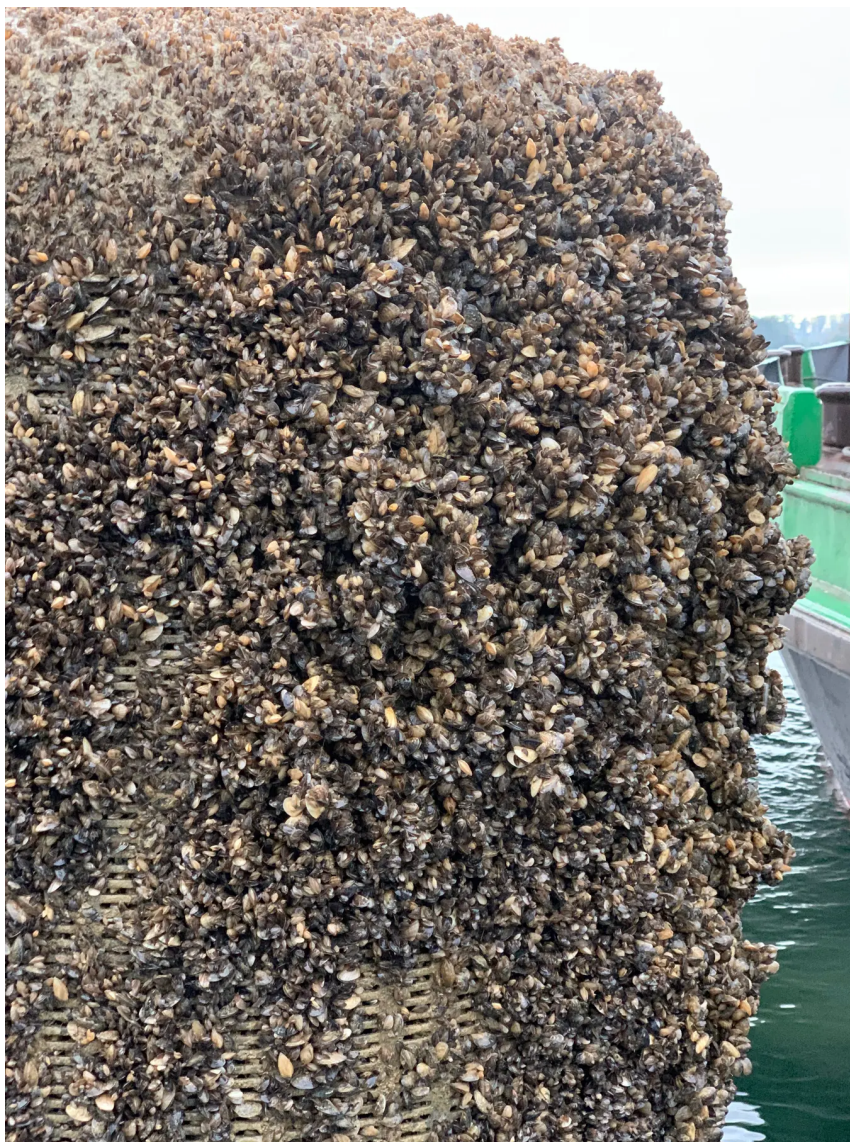
Der vor Goldach an die Oberfläche gezogene Schutzkorb zeigt das Ausmass der Quagga-Muschel-Plage.
