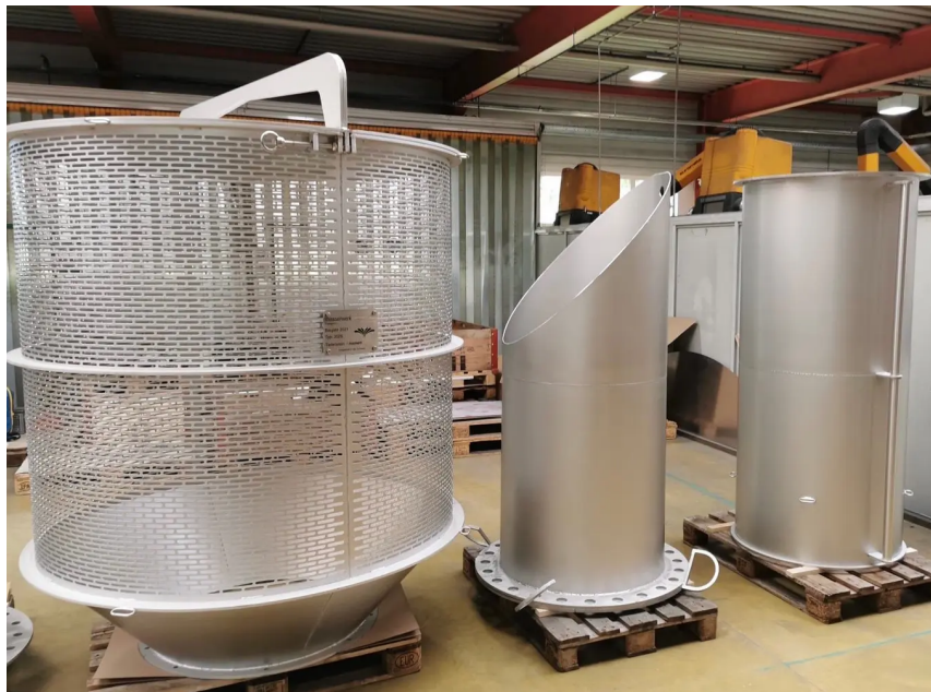
(2) Der Schutzkorb (Seiher) mit der Rohrverlängerung und dem Adapterrohr.
