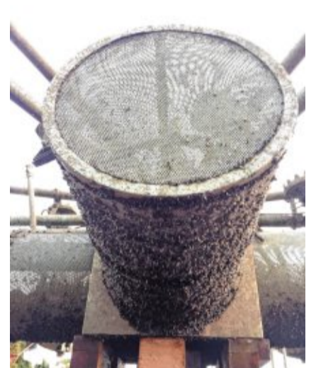
Herausforderung Quaggamuschel: Hier bevölkert sie ein Bauteil der Seefontäne von Friedrichshafen. ARCHIVBILD: KATY CUKO
