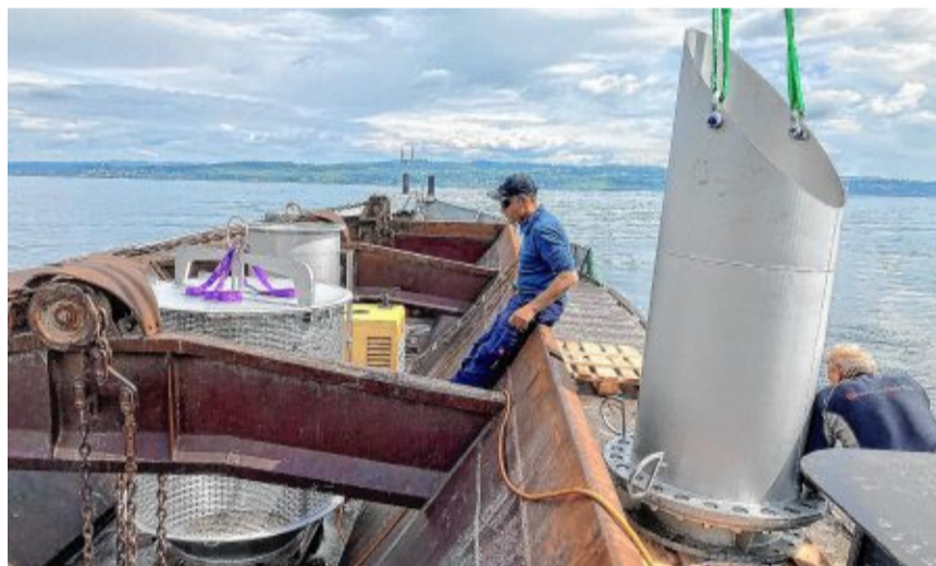
Der Kapitän des Kranschiffs (links) ist auf dem Weg zum Entnahmekorb, um das lila Band zu fixieren. Mit dem Band wird der Korb am Kran-Arm befestigt, um anschließend ins Wasser gehoben zu werden.
